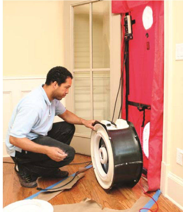
Blower Door Setup in Door Frame
